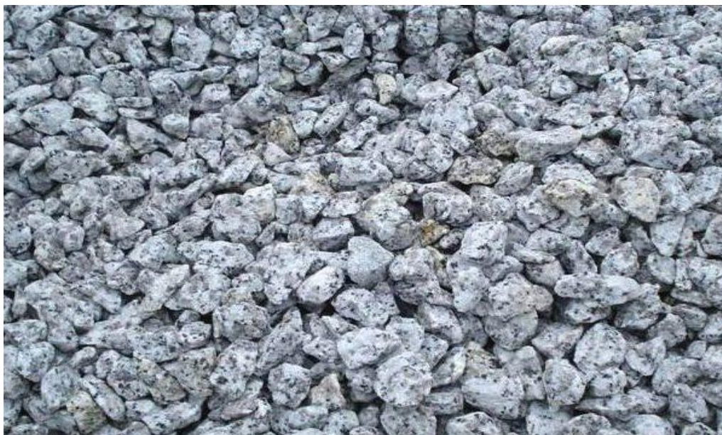
Zdj. 12. Grys granitowy frakcja 1,6- 3,2 cm.
