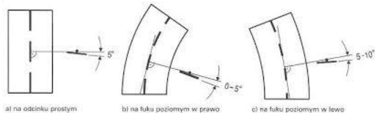
Rys. „Odchylenie poziome tarczy znaku”
