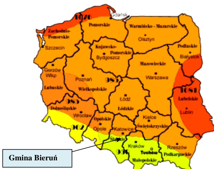
Rys.4. Rejonizacja średniorocznych sum promieniowania słonecznego całkowitego padającego na jednostkę powierzchni poziomej w kWh/m 2 /rok
