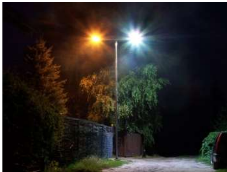
RYСУNEK 3 FOTOGRAFIA PRZEDSTAWIAJĄCA OŚWIETLENIE ŹRÓDŁEM SODOWYM (LEWA STRONA, MOC 75 W) I OŚWIETLENIEM TYPU LED (PRAWA STRONA, MOC 30W),
